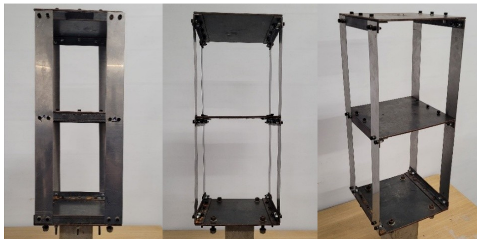
Figura 3 – Pórtico estrutural fabricado / Figure 3 – Manufactured structural frame.
